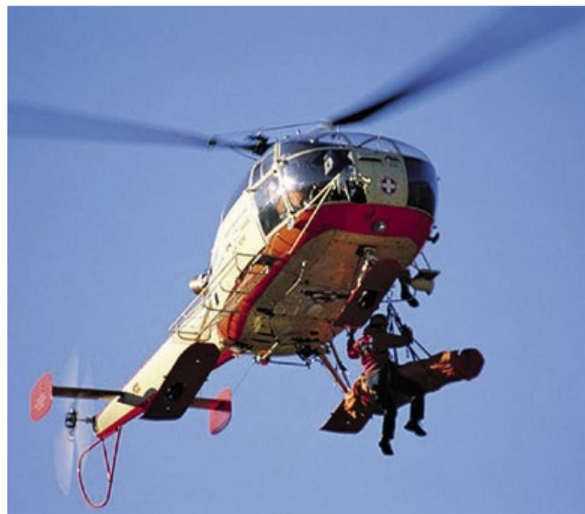
*Die Flugrettung Südtirol in ihren Kinderschuhen: Die Alouette 3, eine einmotorige Maschine, ausgestattet mit einer pneumatischen Seilwinde mit einer Länge von 30 Metern.*
